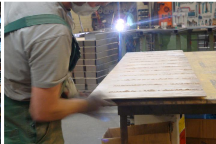
Gehflügel mit Konstruktion aus Stahl, Fa. Riegler Steyr__ Der Stehflügel / Außentafel wird zum Patinieren vorbereitet.
