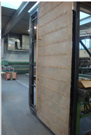
Gehflügel mit Konstruktion aus Stahl, Fa. Riegler Steyr__ Der Stehflügel / Außentafel wird zum Patinieren vorbereitet.
