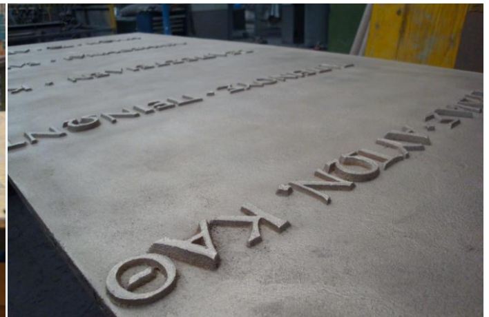
Gehflügel mit Konstruktion aus Stahl, Fa. Riegler Steyr__ Der Stehflügel / Außentafel wird zum Patinieren vorbereitet.
