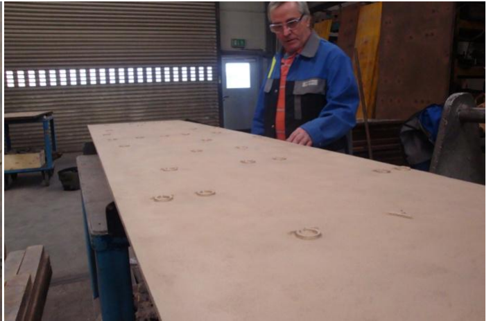
Rohguss: Stehflügel / Außentafel __ Detail: Modelle der Außentafeln nach der Abformung__Der Gießer W. Lughofer mit schmaler Innentafel
